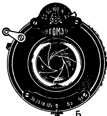
Диафрагма: А — отверстие диафрагмы полностью открыто; Б — отверстие уменьшено.
